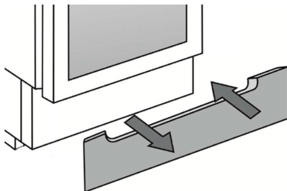
**У встраиваемых в мебельную нишу** винных шкафов нет вентиляционной решетки, и для обеспечения отвода горячего воздуха необходимо предусмотреть сквозную вентиляционную нишу от цоколя до верхней части мебельного модуля (см. рисунок). Площадь вентиляционной ниши должна быть не менее  $200\text{ см}^2$ .
