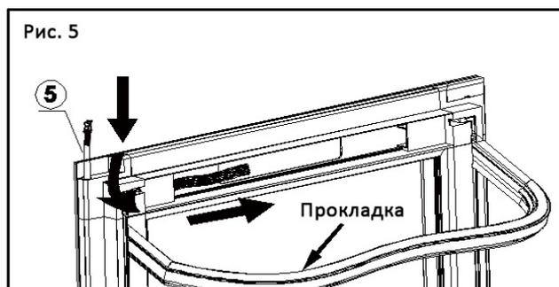
5. Подденьте плоской отверткой защитную крышку с левой стороны двери и снимите её. Вытащите шлейф через отверстие.
