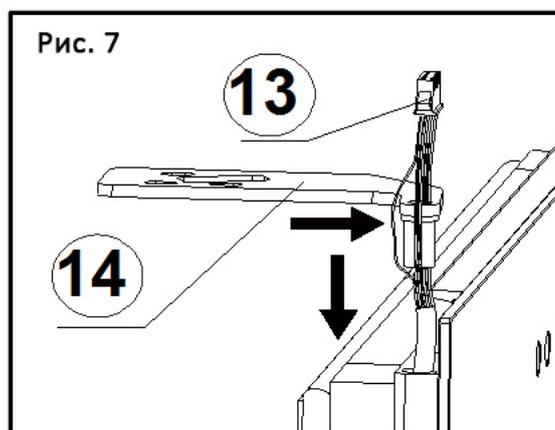
7. Аккуратно вытащите шлейф, чтобы было достаточно места для установки шарнира. Не вытаскивайте шлейф более, чем на 90мм. Просуньте провода внутрь шарнира по одному.
