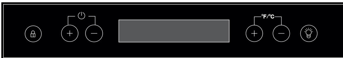
Для регулировки температуры верхней зоны используйте кнопки: **+** (используется для увеличения температуры) или **-** (используется для понижения температуры) с левой стороны, одно нажатие изменяет температуру на 1 градус. Для регулировки температуры в нижней камере используйте кнопки **+** и **-** с правой стороны. Для переключения между °C и °F зажмите кнопки **+** и **-** с правой стороны на 3 секунды. Для включения/выключения освещения внутри шкафа используйте кнопку **💡**.
